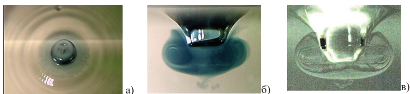
Рис. 1. Картина течений в режиме интрузии ( U = 0,34 м/с, E_\sigma = 4 мкДж, E_k = 2,24 мкДж): а) радиальные петли (вид сверху), б, в) трансформация интрузии в вихревое кольцо при импакте капли чернил и раствора соды
