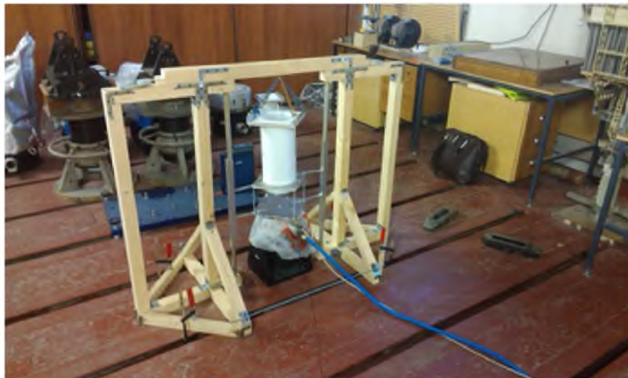
Рис. 4.5. Фотография экспериментальной установки по возбуждению колебаний
