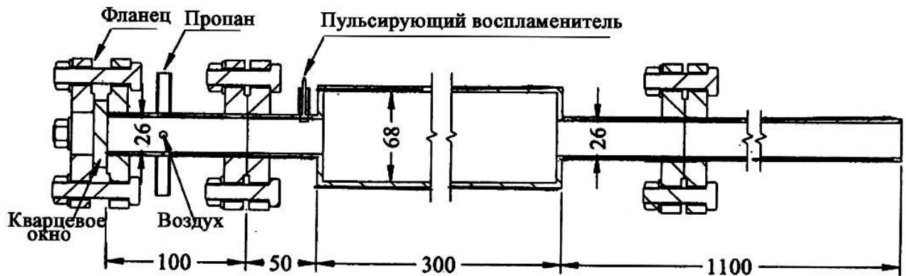
Рис. 86 Схема камеры сгорания ИДД (размеры указаны в миллиметрах).
