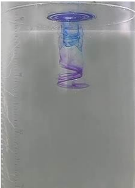
Рисунок 2.3.6 – Эволюция вертикального распределения красителя двух цветов ( H = 40 см, \Omega = 195 об/мин, R = 5,0 см): a, б ) – t = 1, 12 с
