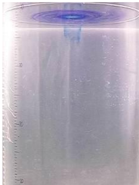
Рисунок 2.3.7 – Эволюция вертикального распределения красителя двух цветов ( H = 40 см, \Omega = 195 об/мин, R = 5,0 см): a, б ) – t = 1, 10 с
