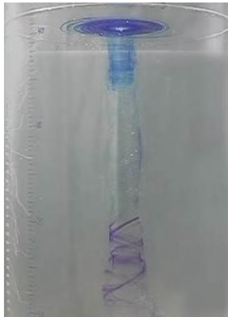
Рисунок 2.3.6 – Эволюция вертикального распределения красителя двух цветов ( H = 40 см, \Omega = 195 об/мин, R = 5,0 см): a, б ) – t = 1, 12 с
