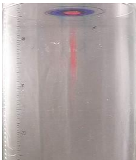
Рисунок 2.3.8 – Вертикальные окрашенные структуры красителя двух цветов ( H = 40 см, \Omega = 400 об/мин, R = 5,0 см): а, б ) – t = 1,7 с
