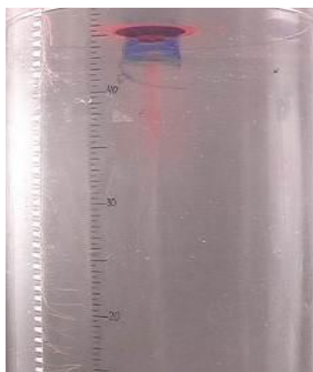
Рисунок 2.3.8 – Вертикальные окрашенные структуры красителя двух цветов ( H = 40 см, \Omega = 400 об/мин, R = 5,0 см): а, б ) – t = 1,7 с
