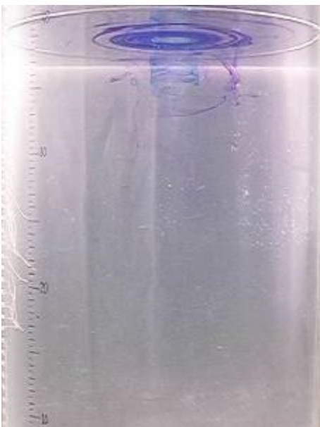
Рисунок 2.3.7 – Эволюция вертикального распределения красителя двух цветов ( H = 40 см, \Omega = 195 об/мин, R = 5,0 см): a, б ) – t = 1, 10 с
