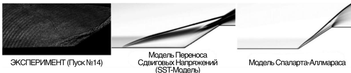
**Рисунок 3.1.6.** Сравнение поведения потока в области «юбки» по данным эксперимента и компьютерного моделирования с использованием SST и Спаларта-Аллмараса (SA) моделей турбулентности
