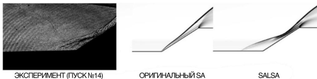
**Рисунок 3.1.8.** Сравнение поведения потока в области «юбки» по данным эксперимента и компьютерного моделирования с использованием оригинальной и модифицированной (SALSA) SA моделей турбулентности
