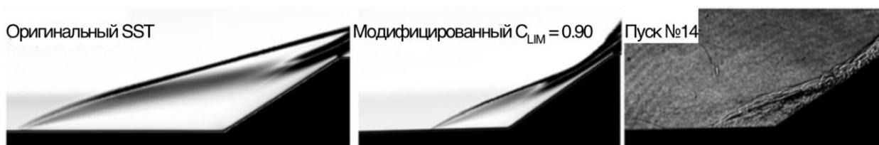
**Рисунок 3.1.7.** Сравнение поведения потока в области «юбки» по данным эксперимента и компьютерного моделирования с использованием оригинальной и модифицированной SST моделей турбулентности
