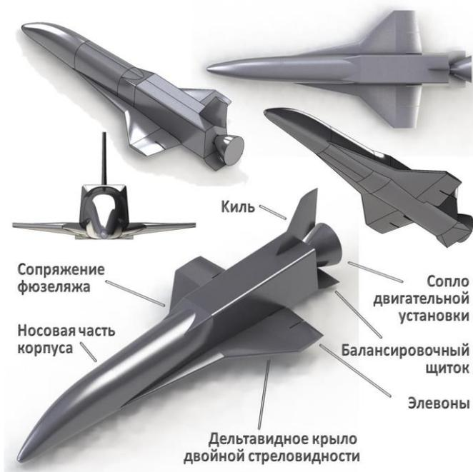
**Рисунок 4.2.2.** Созданная реалистичная 3D поверхность летательного аппарата X-34 в различных ракурсах
