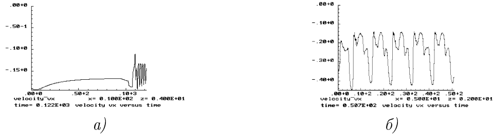
Рис. 7. История горизонтальной скорости в точке x = 10, y = 4 для Re = 4000 и в точке x = 5, y = 2 для Re = 40000 .
